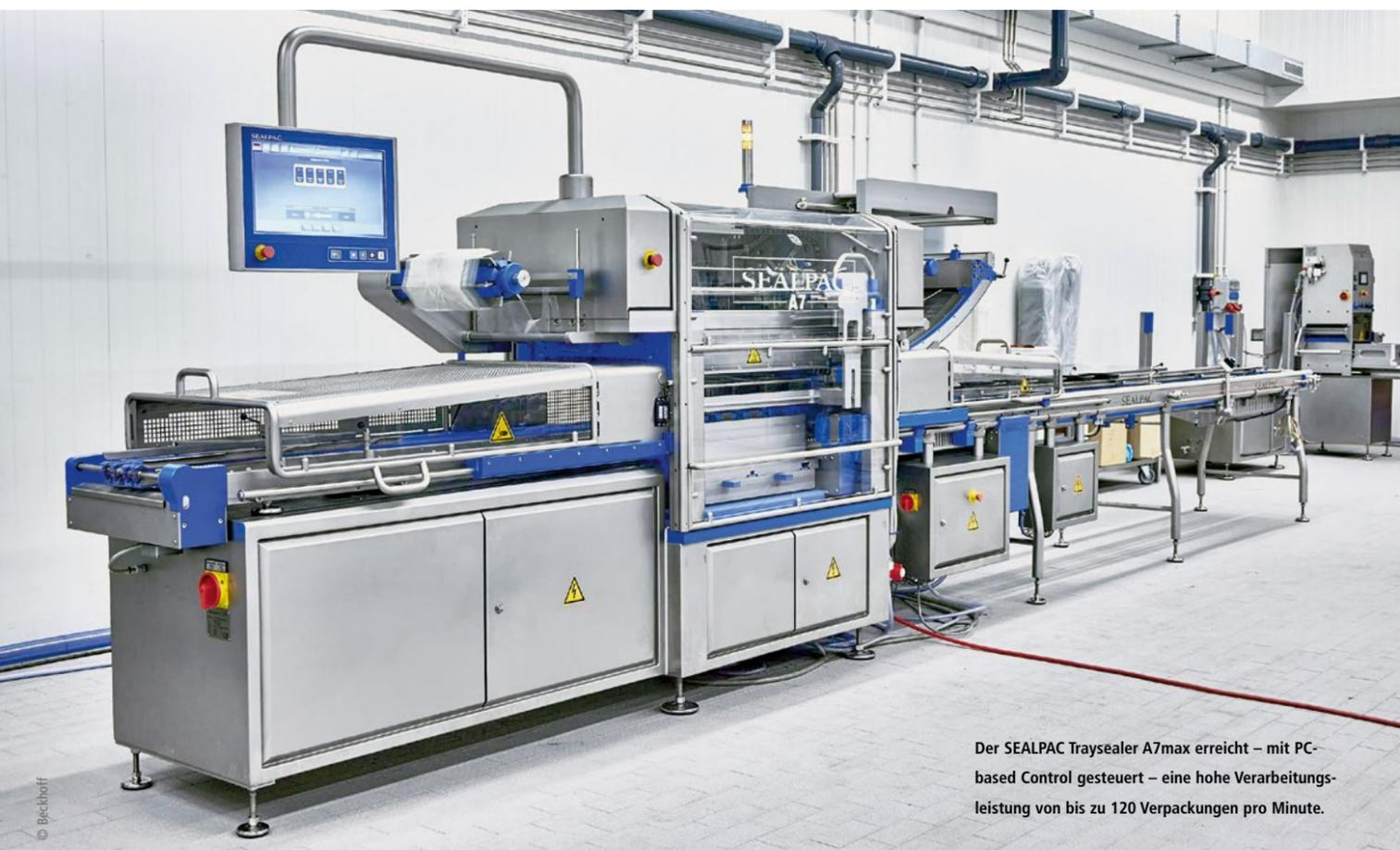
Der SEALPAC Traysealer A7max erreicht – mit PC-based Control gesteuert – eine hohe Verarbeitungsleistung von bis zu 120 Verpackungen pro Minute.
