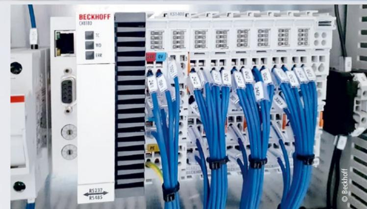
Embedded-PCs CX8180 ermöglichen es INTEREL die individuellen Anforderungen jedes Standorts und dessen vorhandener Infrastruktur optimal zu erfüllen. Denn das benötigte Kommunikationsprotokoll lässt sich nach Belieben auf den Embedded-PCs installieren.
