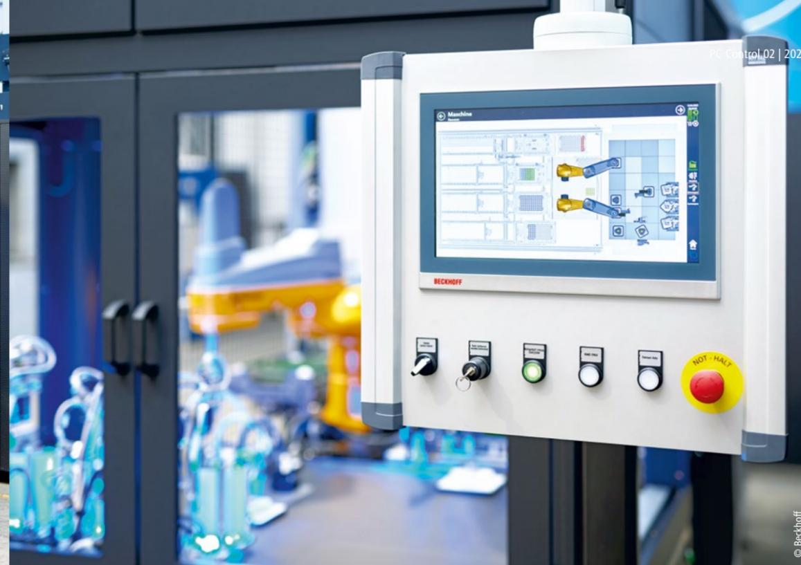
Das Multitouch-Einbau-Control-Panel der Reihe CP29xx ermöglicht eine komfortable Maschinenbedienung und Prozesskontrolle.
