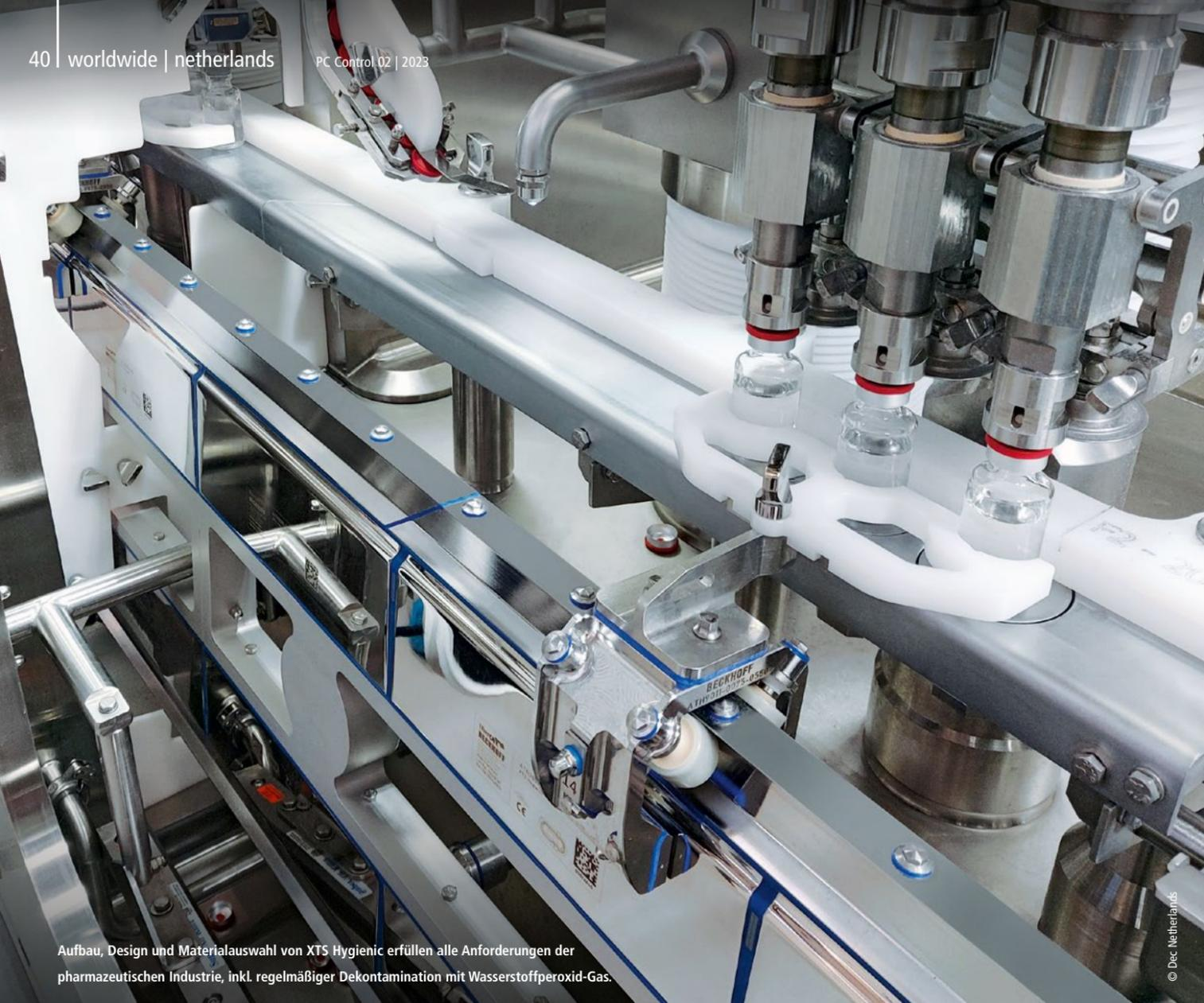
Aufbau, Design und Materialauswahl von XTS Hygienic erfüllen alle Anforderungen der pharmazeutischen Industrie, inkl. regelmäßiger Dekontamination mit Wasserstoffperoxid-Gas.
