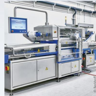
26 | SEALPAC, Deutschland: PC-basierte Steuerungs- und Antriebstechnik bei Verpackungsmaschinen für die Lebensmittelindustrie
