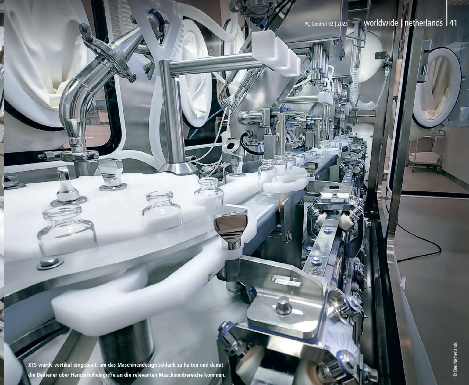
XTS wurde vertikal eingebaut, um das Maschinendesign schlank zu halten und damit die Bediener über Handschuh Eingriffe an die relevanten Maschinenbereiche kommen.
