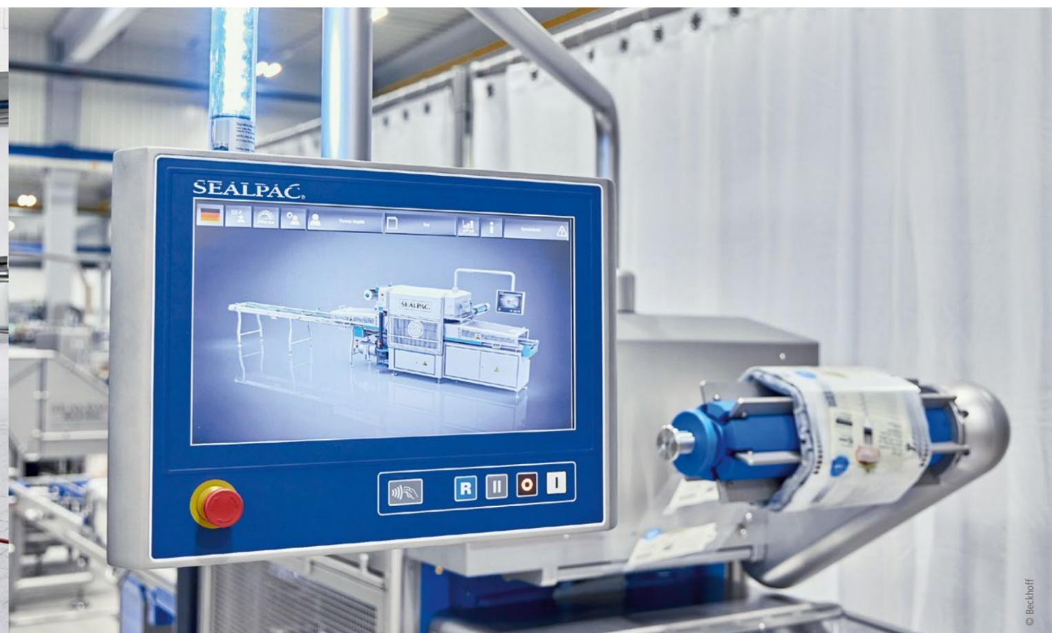
PC-basierte Steuerungs- und Antriebstechnik bei Verpackungsmaschinen für die Lebensmittelindustrie
