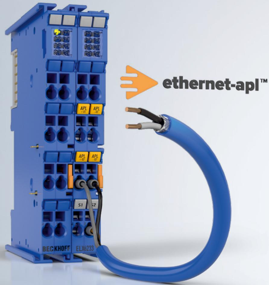
An die EtherCAT-Klemme ELX6233 von Beckhoff lassen sich Ethernet-APL-fähige Feldgeräte aus den explosionsgefährdeten Bereichen der Zonen 0/20 und 1/21 direkt anschließen. Damit ermöglicht die Kombination aus flexibler EtherCAT-Systemarchitektur und breitem ELX-Portfolio nun die Integration von Ethernet-APL-, HART- oder einfachen Digital-Signalen in einem Klemmenstrang.
